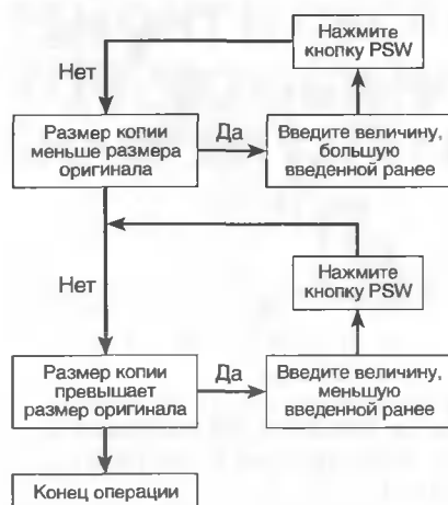
Рис. 8. Последовательность регулировки масштаба копирования
