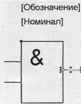
Рис. 12. Неоконченный чертеж логического элемента И-НЕ
