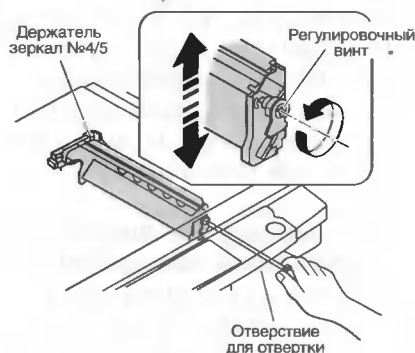
Рис. 12. Регулировка высоты держателя зеркал № 4/5
