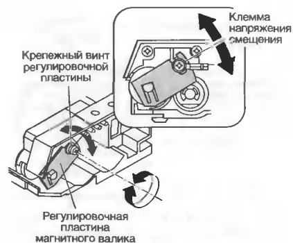
Рис. 4. Регулировка положения главного полюса магнитного валика
